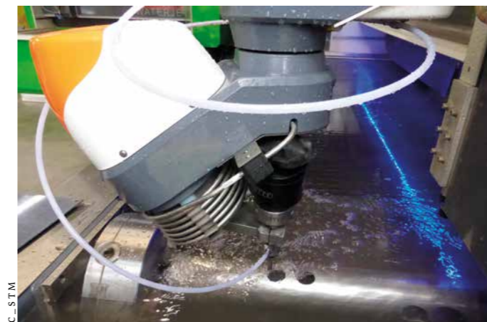
Der österreichische Technologiepionier STM hat ein Rohrschneidemodul entwickelt, das alle Standard-Schneidaufgaben vollautomatisch löst.
